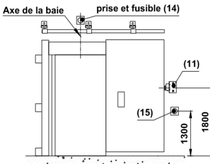
**Equipements associés :** Déclencheur électromagnétique
